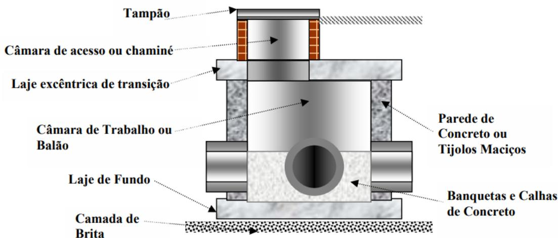
Figura 4- Detalhe de um poço de visita.
