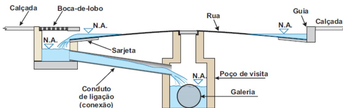
Figura 3 - Poço de visita e demais dispositivos de drenagem
