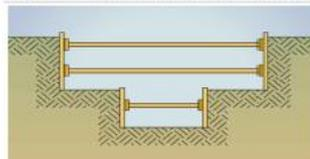
Figura 7 – Escavação taludada (proteção com painéis em taludes)
