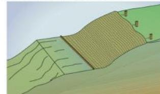
Figura 8 – Escavação protegida – com estruturas denominadas "cortinas"
