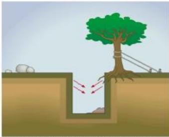
Figura 1 – Escavação com corte de queda de árvores, deslizamento de rochas, etc.
