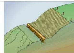
Figura 9 – Escavação rasa – com paredes em talude e com painéis protegidos por cortinas
